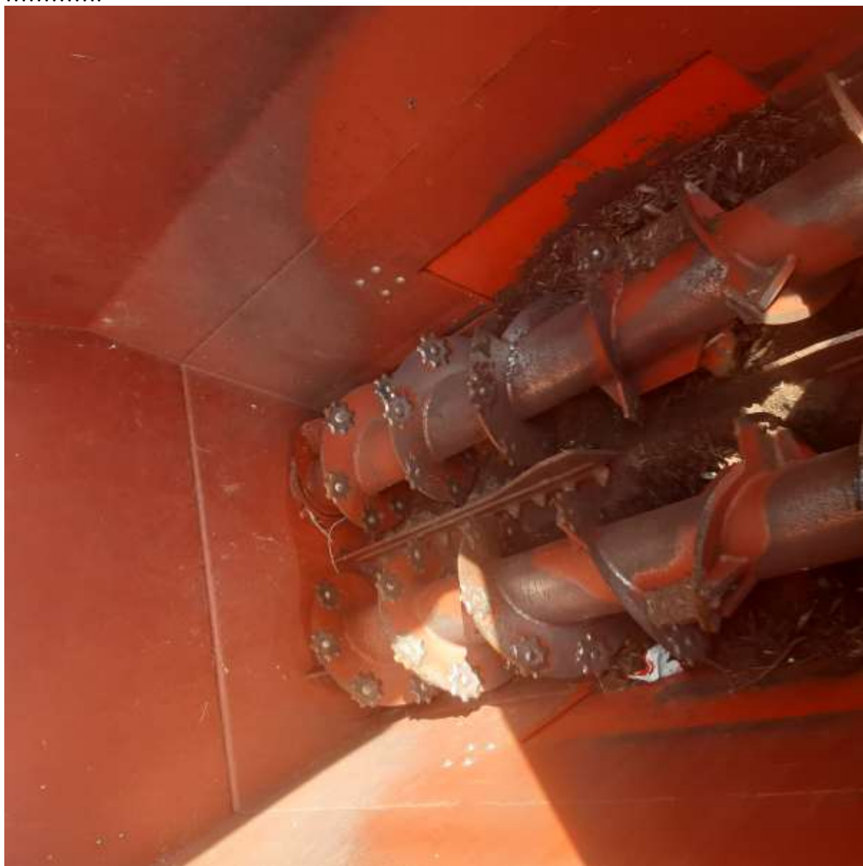
Zdjęcie nr 4. Rozdrabniarko – mieszarka SAMURAI 5 włoskiej firmy SECO Sp.A 400/50
